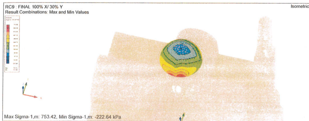
Εικόνα 28. Κύριες τάσεις κατά τη διεύθυνση 1 – Τρούλος Σεισμική φόρτιση 100X – 30Y.
