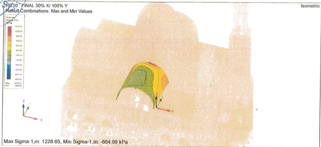
Εικόνα 38. Κύριες τάσεις κατά τη διεύθυνση 1 – Νότια καμάρα Σεισμική φόρτιση 30X – 100Y.
